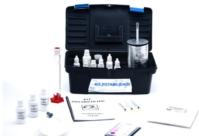
Figura 5 - Kit técnico de potabilidade da empresa ALFAKIT utilizado para análise de parâmetros físico-químicos e microbiológicos.
