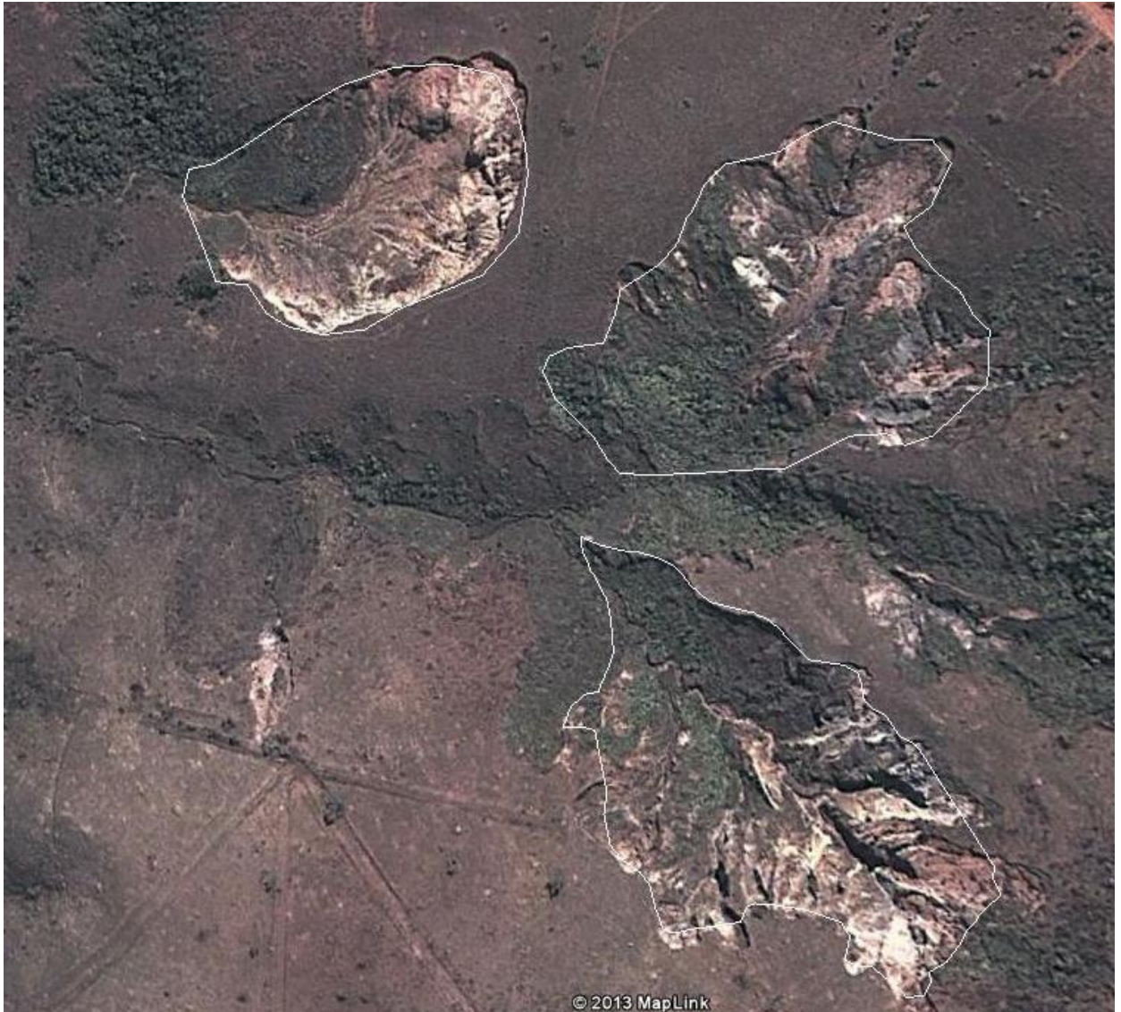
FIGURA 17 – VISTA AÉREA DE PROCESSOS EROSIVOS EM ESTÁGIO AVANÇADO, DELIMITADOS COM AUXÍLIO DE IMAGENS DE ALTA RESOLUÇÃO ESPACIAL – PORÇÃO NOROESTE DA BACIA. FONTE: GOOGLE EARTH.
