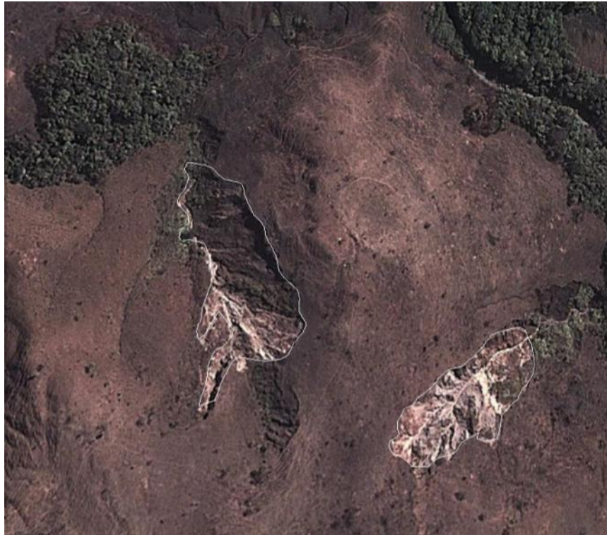
FIGURA 51 - PROCESSOS EROSIVOS EM ESTÁGIO A AVANÇADO SOBREPOSTOS A ZONAS AQUÍFERAS 2. FONTE GOOGLE EARTH, 2011.
