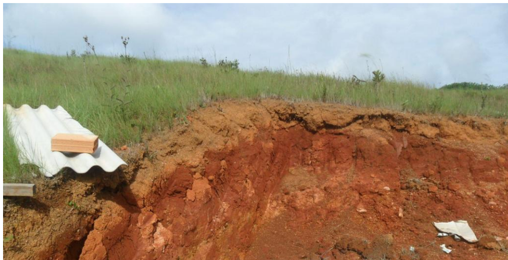
FIGURA 70. LATOSSOLO FÉRRICO SOB VEGETAÇÃO DE CAMPO ENCONTRADO NA SUBBACIA DO RIBEIRÃO DO SILVA. FONTE: MYR, 2013.
