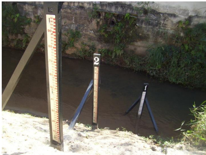
Figura 4.14 – Régua de medição de cheias no Córrego Caeté, monitorado pelo CPRM e nível de máxima cheia ocorrida em 2008 (direita).
