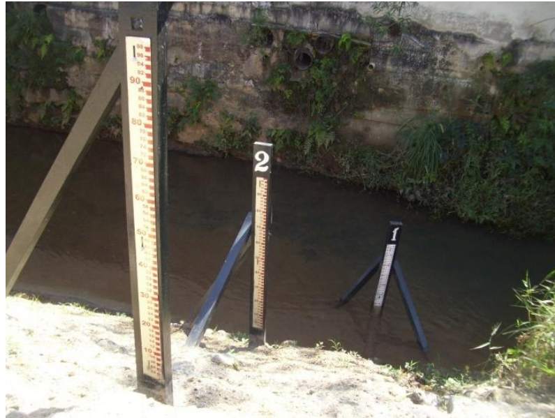
Figura 7.27 - Réguas linimétricas utilizadas para o monitoramento hidrológico no Rio Caeté, pelo CPRM – Regional Caeté
