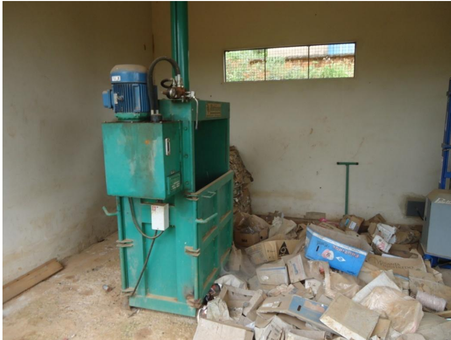
Figura 7.107 - Prensa hidráulica vertical
