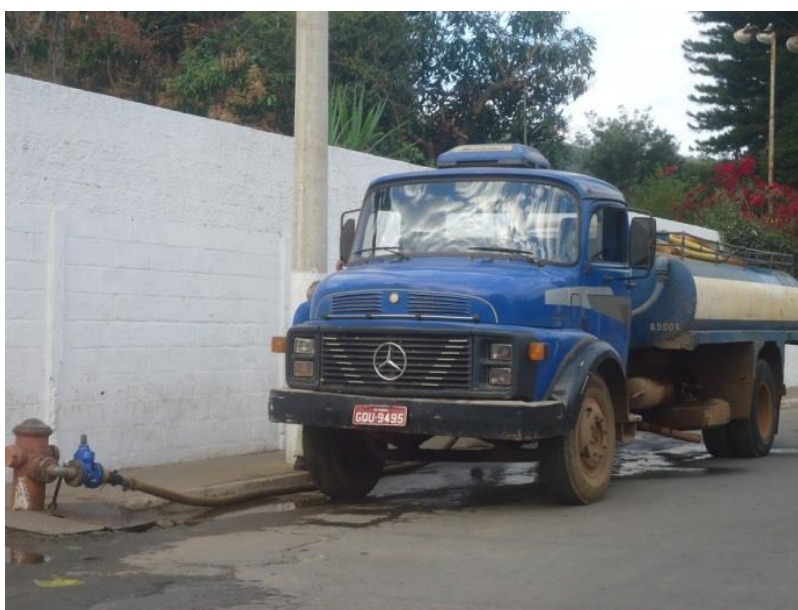
Figura 7-93 – Abastecimento de caminhão pipa
