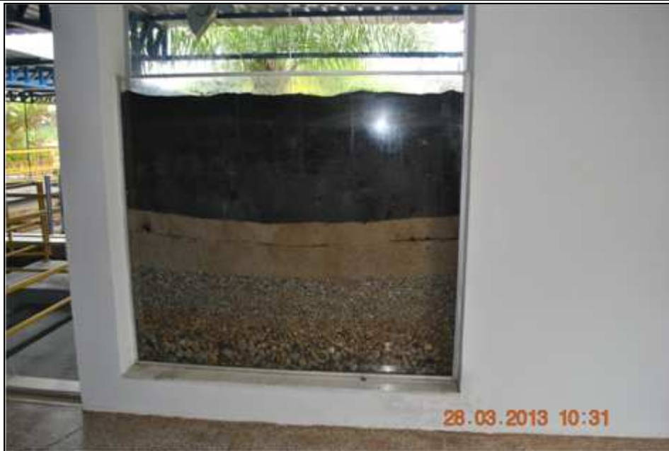
Figura 20. Maquete do Filtro Existente na ETA da Sede Fonte: DRZ Geotecnologia e Consultoria (2013)
