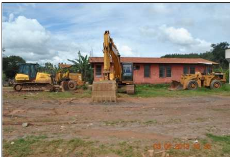
Figura 78. Tratores para Espalhamento e Compactação dos Resíduos Fonte: DRZ Geotecnologia e Consultoria (2013)
