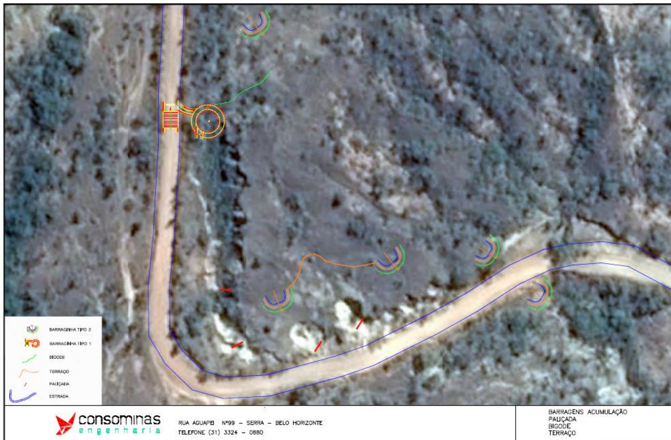
Figura 32: Intervenções para disciplinamento e contenção das águas de enxurrada causadoras da erosão
