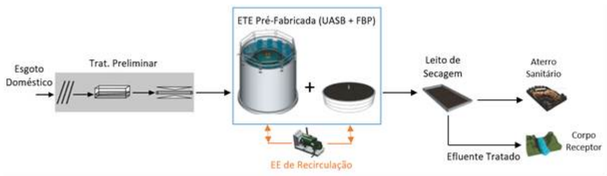
Figura 4.1 – Fluxograma de funcionamento da ETE de São Vicente.
