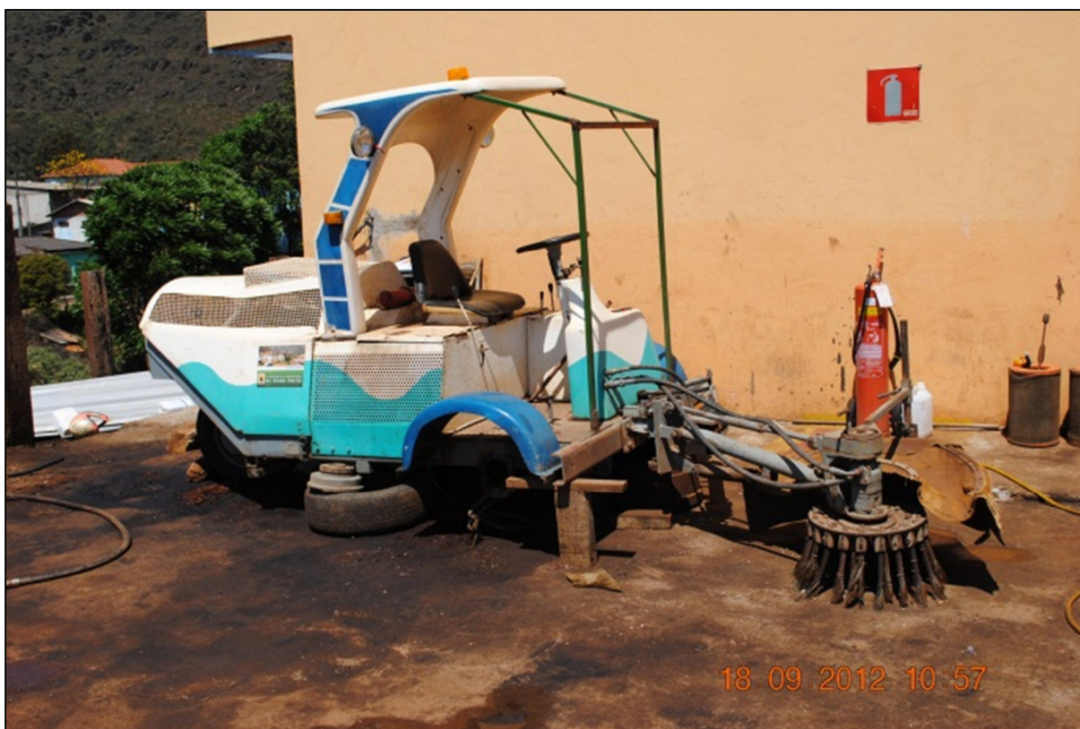
Figura 108. Equipamento para capina de grama no pavimento tipo poliedro.
