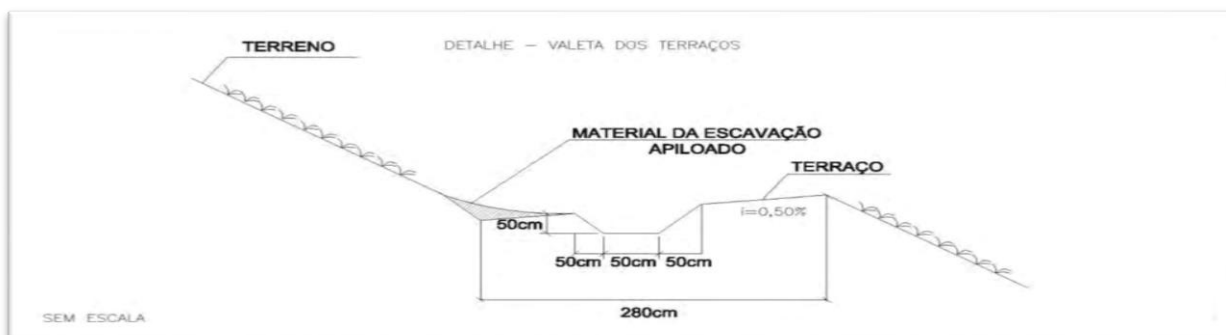
Figura 9: Detalhe dos terraços
