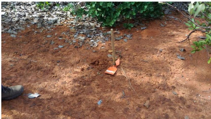
**Figura 33 – Coleta de amostra de solo próxima à nascente do Córrego “sem nome” para classificação tátil-visual (558257,534 E - 7971169,933 S)**
