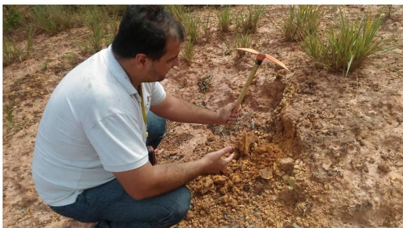
**Figura 26 – Coleta de amostra de solo próxima à nascente do Córrego Curralinho para classificação tátil-visual (555504,157 E - 7971044,199 S)**
