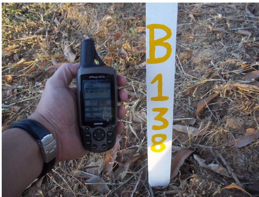
Figura 5.10 – Exemplo de estaqueamento proveniente de locação topográfica
