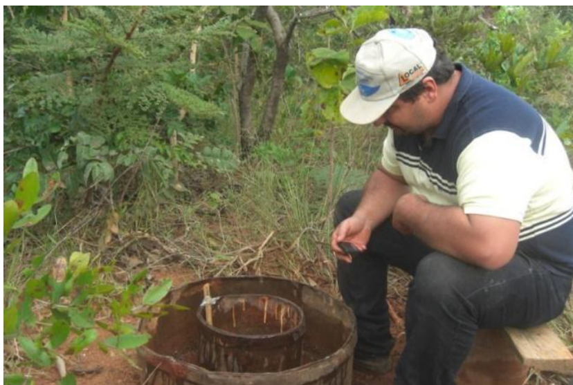
Figura 78 – Realização do teste de Infiltrômetro de Anéis Concêntricos na área de recarga da sub-bacia do Córrego Matadouro - projeto hidroambiental UTE Ribeirão Picão
