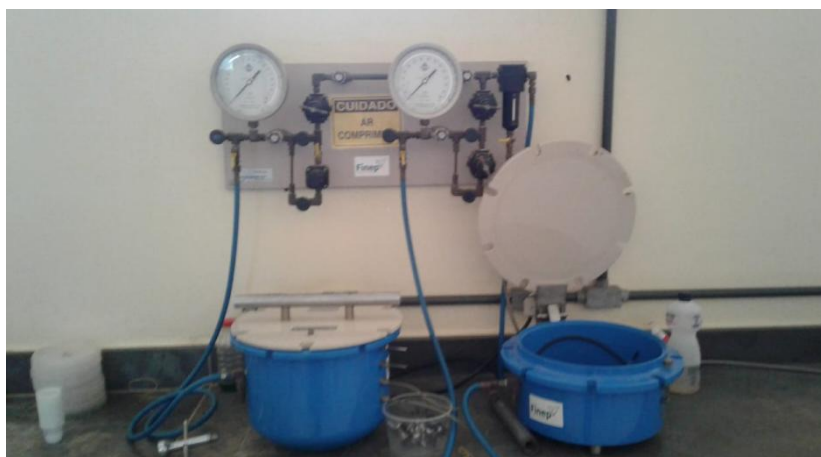
Figura 21 – Determinação do DTA através da câmara de pressão de Richards
