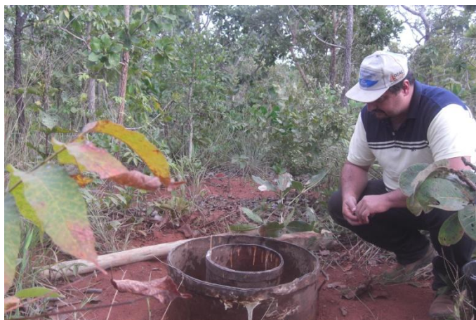
Figura 18 – Realização do teste de Infiltrômetro de Anéis Concêntricos
