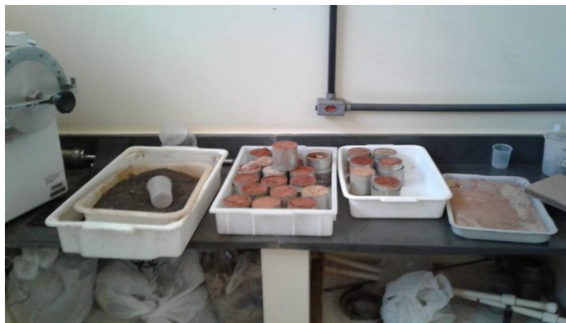
Figura 20 – Preparo das amostras de solo coletadas para determinação do DTA em laboratório
