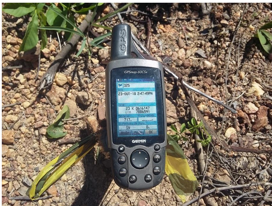
Figura 6.1 – GPS Utilizado no Levantamento Topográfico
