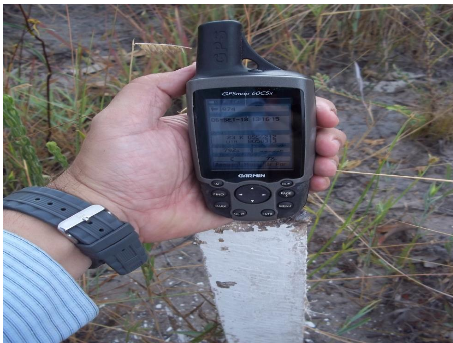
Figura 6.1 – GPS utilizado no levantamento topográfico
