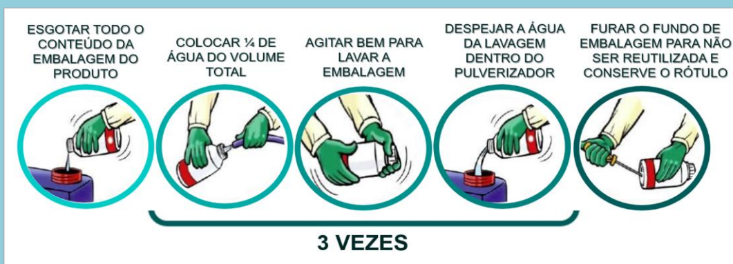
Figura 9. Processo da tríplex lavagem das embalagens de defensivos agrícolas.
