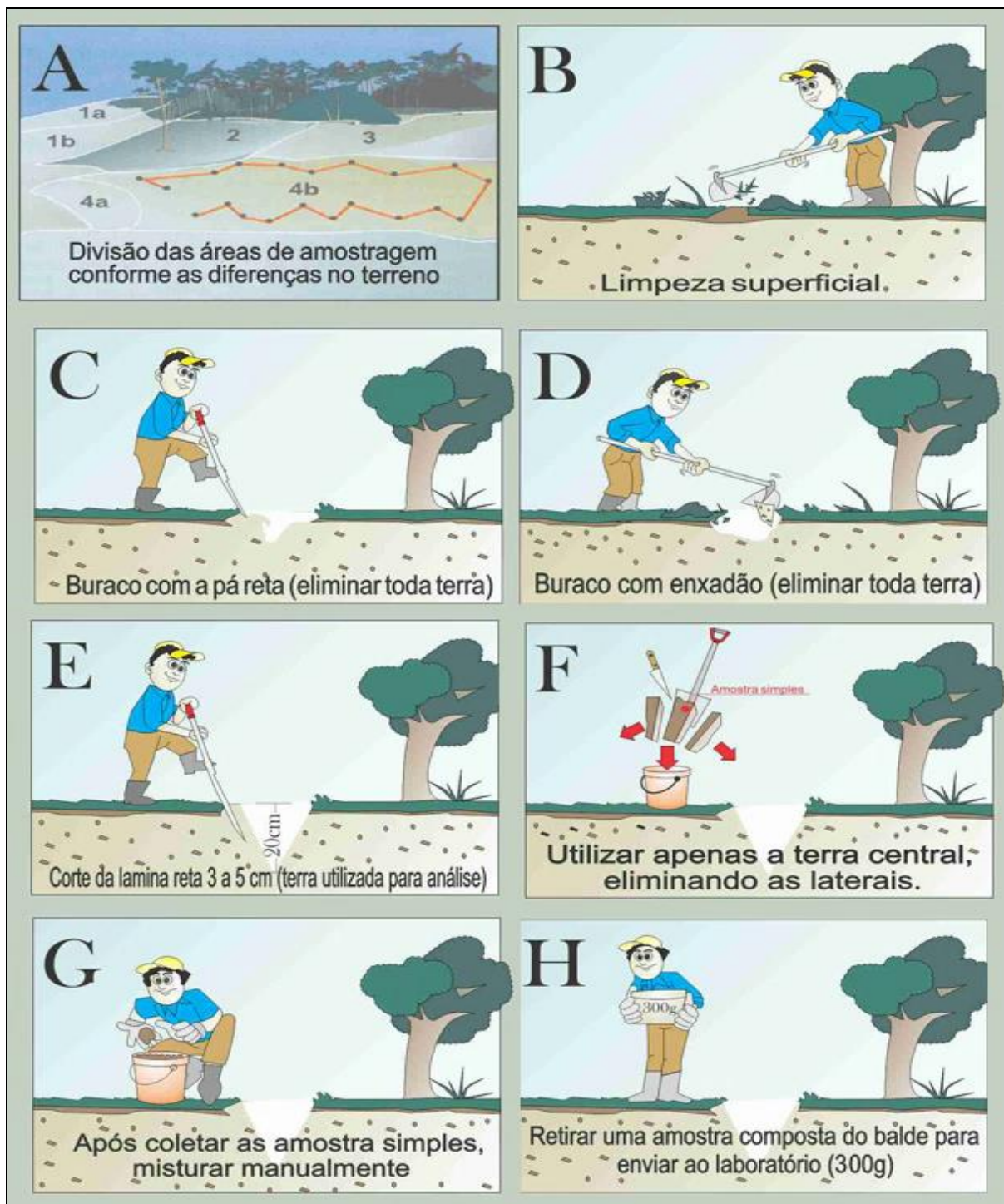
Figura 15. Explicação geral sobre o passo a passo para coleta de amostra de solo para análise
