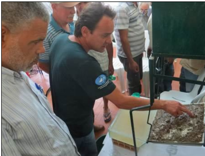
Foto 30 - Demonstração dos efeitos da erosão no “simulador de chuva”. Fonte: Arquivo Fotográfico da GOS Florestal
