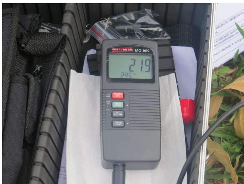
Foto 3: Equipamento utilizado para análise de Oxigênio dissolvido que é realizada em campo pelos técnicos da GOS Florestal.
