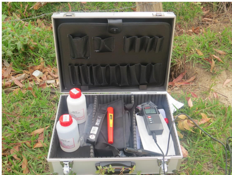
Foto 2: Equipamentos utilizados para análises de pH e Oxigênio dissolvido que são realizadas em campo pelos técnicos da GOS Florestal.
