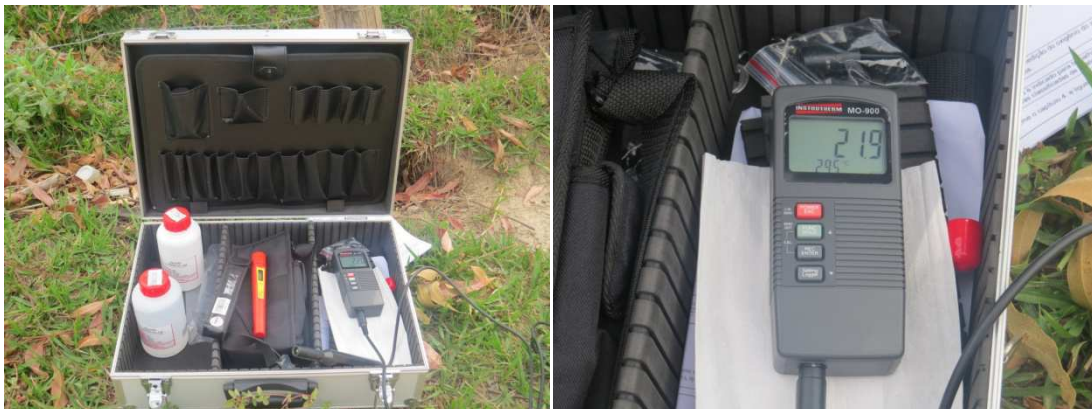
Figura3: Equipamentos utilizados para análises de pH e oxigênio dissolvido realizadas em campo pelos técnicos da GOS Florestal.
